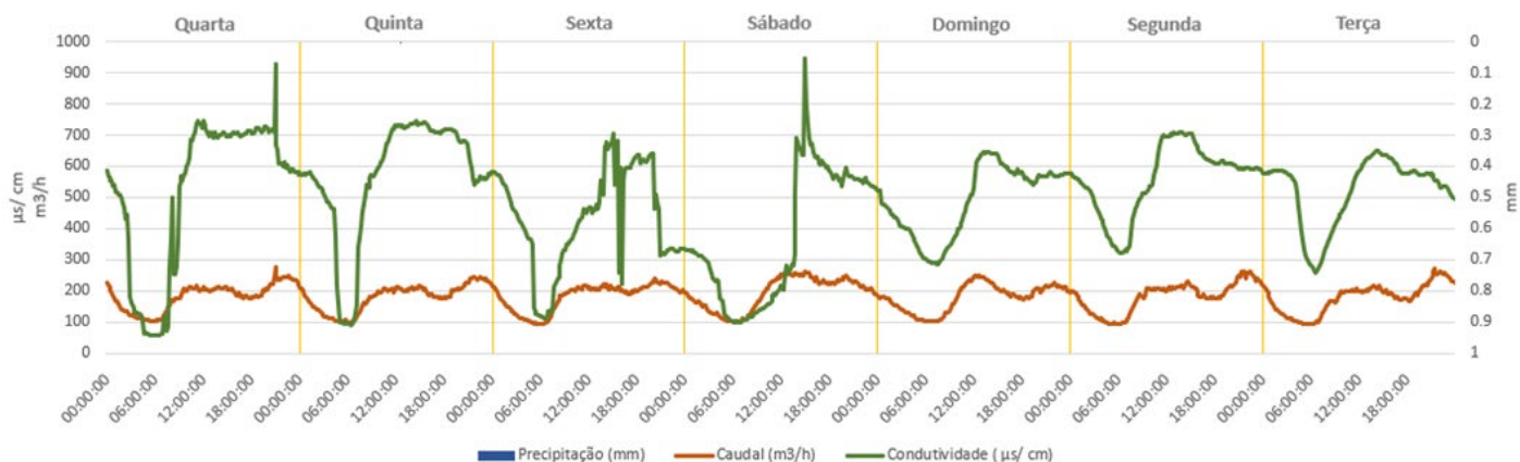
Figura 3. Registo de condutividade e de caudal no período de 21 de junho a 27 de junho de 2023 sem eventos de pluviosidade
