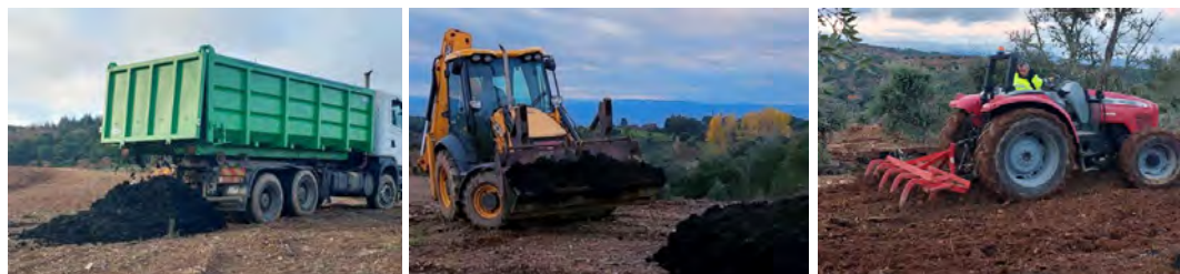
Figura 5. Camião na descarga dos Biossólidos, Pá carregadora e Escarificador, utilizados para a execução do processo de espalhamento e incorporação de biossólidos (AdNorte, 2023)
