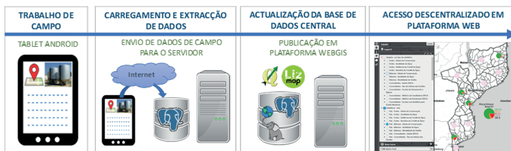
Figura 1. SINAS – Arquitetura geral do sistema implementado
