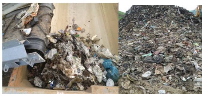
Figura 5. Resíduos minerados antes (à esquerda) e depois do pré-tratamento (à direita)
