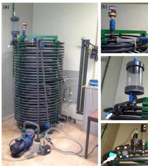
Figura 1. Sistema piloto no IST (a) vista geral; (b) válvula para remoção do ar e trecho transparente para inspeção visual; (c) pequeno reservatório para reposição dos volumes amostrados; (d) sensores de temperatura e de condutividade
